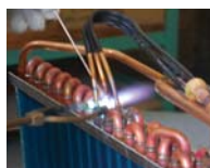
Soudures incluant 5% d'argent pour une résistance accrue
